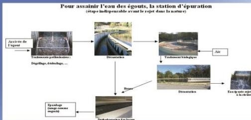
Schéma simplifié d'une station d'épuration
